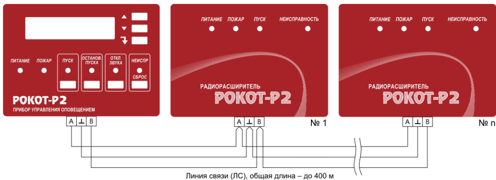
Рис.1 Подключение ПУО и РР к линии связи
